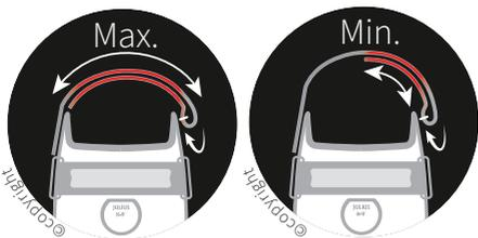
La conception Julius-K9 (1997) consiste en une ceinture au niveau du poitrail pouvant être ouverte et ajustée à l'aide d'une bande velcro. La ceinture doit être attachée en la passant à travers un anneau du côté du poitrail du chien. Dans l'intervalle situé entre le réglage minimum et maximum, elle maintient plusieurs fois le poids du chien.
